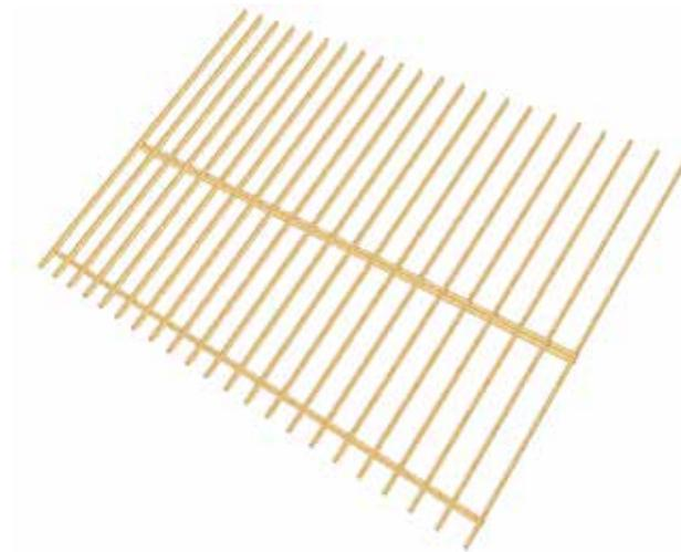
**Figura 7.1:** Esempio di copertura monofalda
