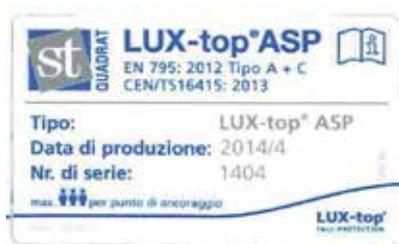
Figura 13.5: Etichetta visibile sui dispositivi di ancoraggio LUX-top ASP
