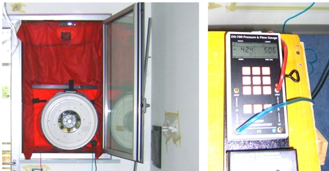
Figura 5 La prova di tenuta all'aria di un edificio con "Blower door test". La prova consiste nel forzare una condizione di sovra pressione (o depressione) degli ambienti interni attraverso l'uso di un ventilatore. Attraverso la misurazione della portata d'aria necessaria a mantenere una differenza barometrica tra interno ed esterno di 50 Pascal si ricava per via indiretta la qualità della tenuta all'aria dell'edifici.
