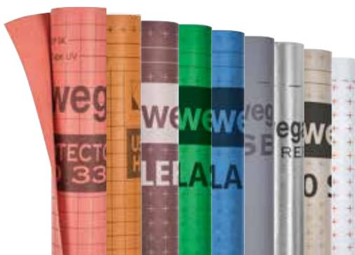
In Italia, nella maggior parte delle tipologie dei tetti, gli SMT ammessi sono quelli in classe non inferiore alla B (grammatura superiore a 145 g/m<sup>2</sup>) con pendenze superiori o uguali al 30% (16,7°) e non inferiore alla A (grammatura superiore a 200 g/m<sup>2</sup>) con pendenze inferiori al 30% (16,7°). Nel caso di posa su superfici in CLS, gli SMT ammessi sono quelli in classe non inferiore alla A (grammatura superiore a 200 g/m<sup>2</sup>).
