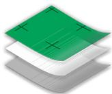
Strato protettivo superiore idrorepellente, stabilizzato ai raggi UV al 4-5%
