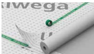
**Le sovrapposizioni dell'SMT** devono seguire le linee di sormonto indicate sul bordo dell'SMT stesso e quindi sigillate\* tramite gli appositi nastri adesivi acrilici (USB Tape) oppure tramite il collante acrilico incorporato nella versione TOP SK.
