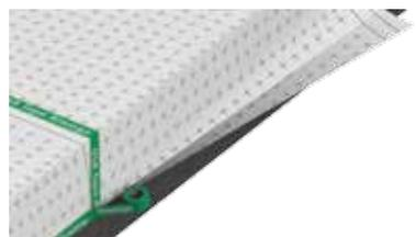
L'SMT deve essere sigillato sulle superfici su cui viene risvoltato oppure interrotto o tagliato, utilizzando gli appositi nastri adesivi acrilici (USB Tape) o butilici (USB Coll) per garantire perfetta tenuta all'aria ed al vento della struttura\*.
