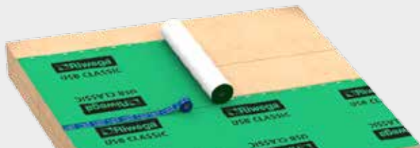
Abdichtung der diffusionsoffenen USB-Dachbahnen von Riwega gegen Luft, Wasser, Wind und Dampf an den Überlappungen auf dem Dach
