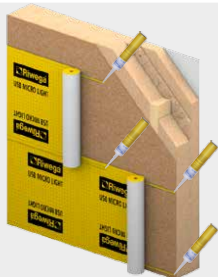
Verkleben des USB-Dampfbremsen von Riwega innen auf Holzwänden oder OSB-Platten mit Versiegelung der Überlappungen.
