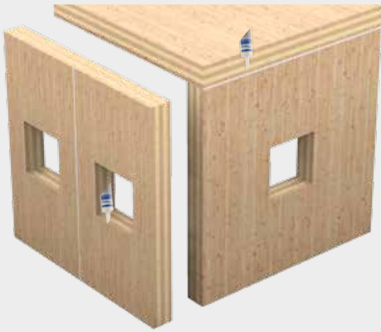
Versiegelung der Verbindungsstelle zwischen zwei Holzwänden und Holzwänden und Zwischendecken.
