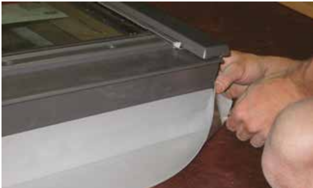
3. Der Liner wird zuerst am oberen, dann am unteren Teil abgezogen
