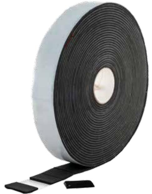
**Description du produit :** garniture point clou adhésif à simple pièce et en mousse PVC qui garantit l'étanchéité à l'eau entre la membrane USB Riwega et les contre-liteaux de ventilation, pour éviter les infiltrations d'eau dans les points sur lesquels la vis de fixation du contre-liteau est amenée à percer la membrane. Disponible en 60x40 ou 80x80 mm.
