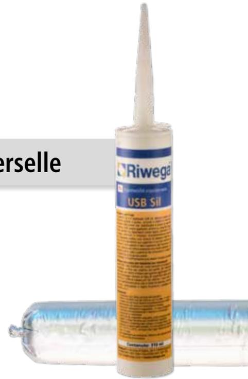
**Description et utilisation :** adhésif scellant en cartouche, copolymère à base d'ester d'acide acrylique avec additifs, sans solvants, prêt à l'emploi, avec du plastique durci, inodore, résistant à l'humidité, avec des propriétés thixotropiques, à haute adhésivité initiale. USB Sil forme une masse adhésive avec une tenue à l'air, au vent et à l'eau selon les conditions requises par les normes EnEV 2002 et DIN 4108-7. Étudié pour le collage et le scellement des chevauchements
