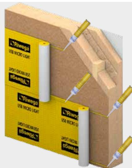
Collage des écrans frein-vapeur USB Riwega à l'intérieur des parois en bois ou sur l'OSB avec scellement des chevauchements
