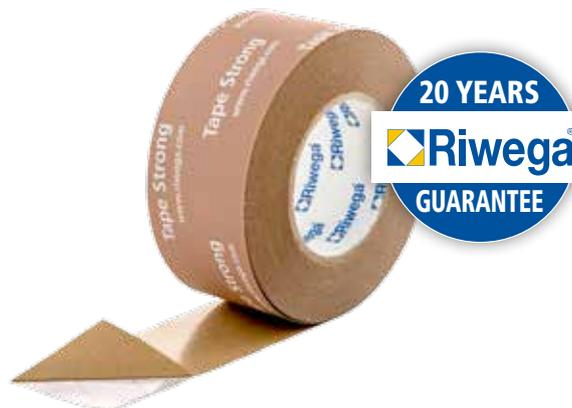
**Description et utilisation :** USB Tape Strong est une bande adhésive pour l'étanchéité à l'air, à l'eau et au vent de tous les points singuliers de l'enveloppe du bâtiment. Grâce à ses propriétés adhésives, elle peut être utilisée pour les superpositions des écrans HPV, frein et pare vapeur mais aussi des interruptions des structures (panneau OSB, bois, béton, crépi) et les ouvertures de la couverture.
