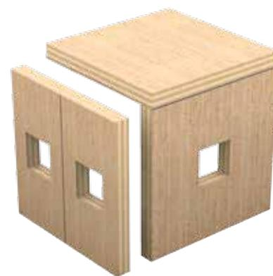
Étanchéfier au moyen de USB BU/CO de la jonction entre deux parois en bois et entre paroi et plancher en bois.
