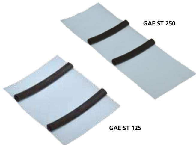
**Description et utilisation :** garniture composée d'une feuille en polyéthylène associée à deux tubes en EPDM élastique de 10 mm diamètre. La garniture garantit une double fonction : le polyéthylène évite le passage de l'humidité sur les poutres en bois; les tubes en EPDM évitent le passage de l'air à travers les fissures jusqu'à 10 mm de largeur. Grâce
