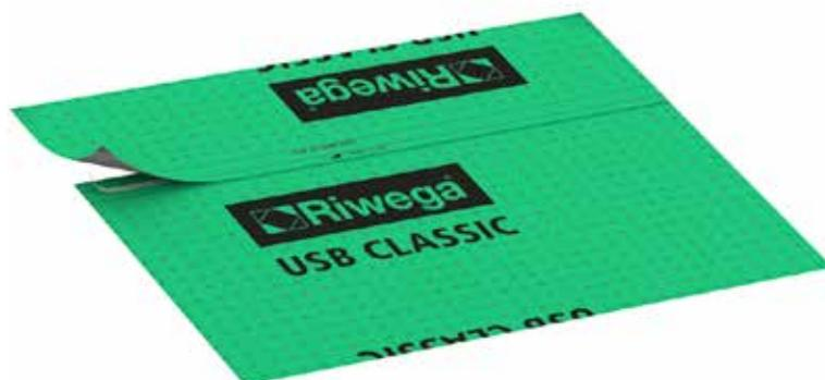
**Description et utilisation :** ruban double face à colle acrylique avec toile de renfort en polyester et à haute adhésivité, spécialement étudié pour le collage des membranes pare-pluie et des écrans frein-vapeur entre une couche et l'autre sur la zone de chevauchement dans le but de créer une surface de la membrane ou de l'écran, pour empêcher le passage de l'air et du vent entre les différentes couches.
