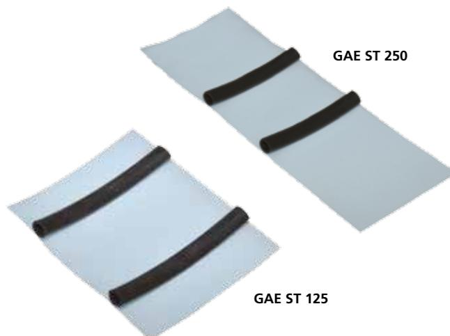
**Descrizione e utilizzo:** guarnizione composta da un foglio in polietilene accoppiato a due tubi in EPDM elastico di diametro 10 mm. La guarnizione garantisce una doppia funzione: il polietilene evita il passaggio di umidità sulle travi in legno; i tubi in EPDM evitano il passaggio d'aria attraverso fessure larghe fino a 10 mm. Grazie all'elasticità
