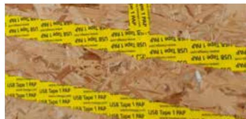
**Descrizione prodotto:** nastro adesivo in carta trattata a PE spalmato di colla acrilica ad alta tenuta adesiva, per uso interno. È stato appositamente studiato per l'incollaggio degli schermi al vapore USB Riwega, ad uso interno, con lo scopo di impermeabilizzare all'aria, al vapore e ai rumori ogni interruzione dei teli sul pacchetto tetto e/o parete. Valido anche per la sigillatura interna di pannelli in legno o OSB delle pareti delle case in legno.
