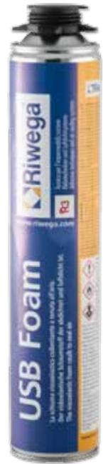
Regolare la quantità emessa attraverso la leva apposita e la vite dosatrice della pistola. Uniformare piccole quantità di prodotto lungo i bordi. Per giunti e cavità superiori a 30 mm riempire in strati ed umidificare tra una posa e l'altra. La schiuma non può essere lasciata per lunghi periodi esposta agli agenti atmosferici in quanto non è resistente ai raggi UV.
