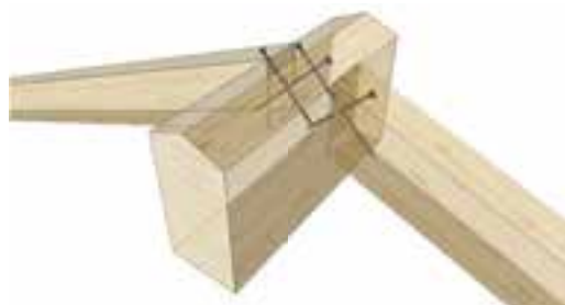
3) Verifiche su connessioni inclinate
