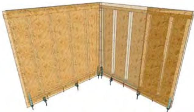
Fig. 9.16 - Connessioni a terra pareti telaio
