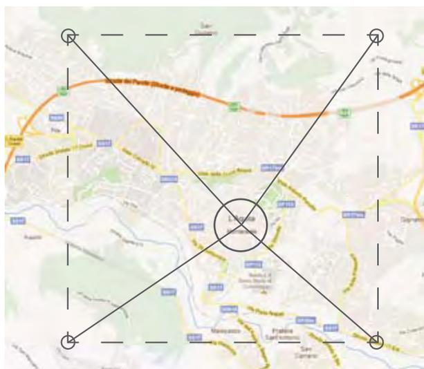
Fig. 3.4 Calcolo della sismicità della città dell'Aquila. La normativa fornisce i parametri sismici nei 4 punti indicati da un cerchio e poi per interpolazione lineare si vanno a calcolare i parametri effettivi nel punto desiderato, in questo caso il centro della città.
