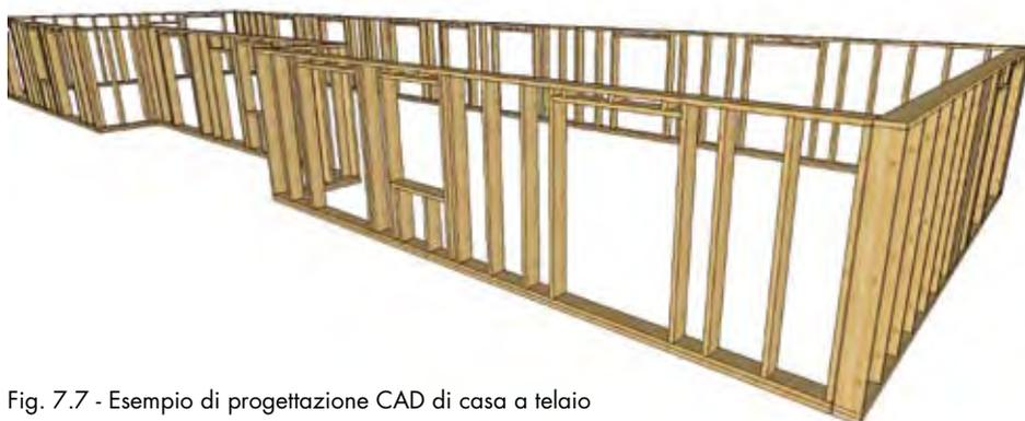
Fig. 7.7 - Esempio di progettazione CAD di casa a telaio
