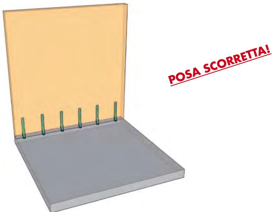
Fig. 9.11 - Disposizione errata
