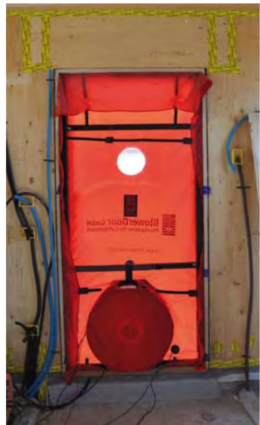
Fig. 10.3 - Strumentazione Blower Door
