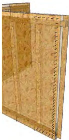
Fig. 9.17 - Fissaggio pannello OSB su parete a telaio
