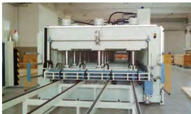
Fig. 7.16 Pressa idraulica per l'incollaggio dei pannelli
