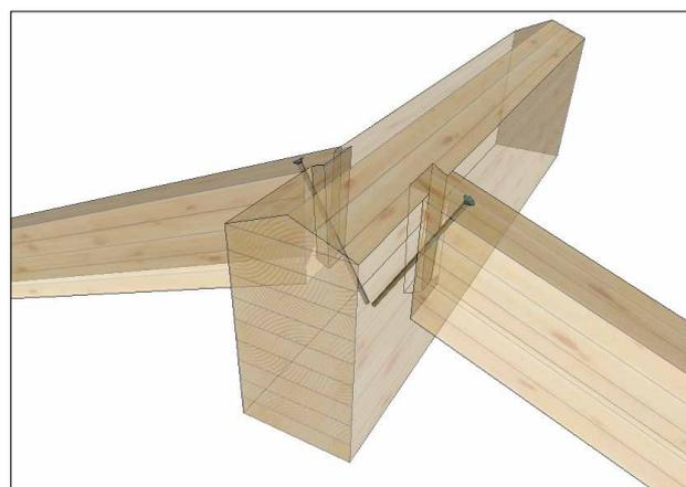
Nota: si raccomanda sempre di fissare una vite su ogni connessione a coda di rondine!
