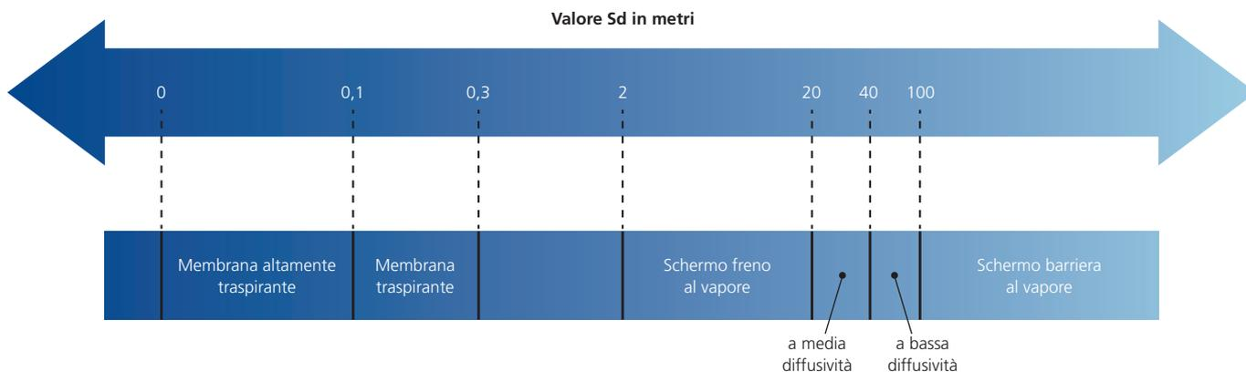
Esistono membrane che possono modificare la propria capacità di trasmissione del vapore e possono ricoprire più categorie tra quelle sopra elencate e vengono definite freni al vapore a igrometria variabile.
