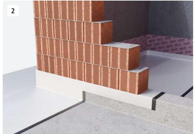
2 Nelle strutture tradizionali, posizionare una barriera al gas radon tra la fondazione e l'edificio. Assicurare la tenuta all'aria con apposito nastro adesivo. Pre-intonacare e se necessario utilizzare il primer.
