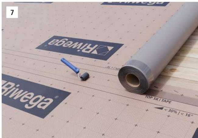
In caso di versione TOP SKI, le membrane vanno sovrapposte seguendo apposita linea di sormonto, facendo coincidere perfettamente le due strisce di colla. Effettuare un'adeguata pressione con apposito rullino.
