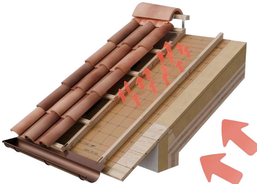
La norma **UNI 11470:2015** chiarisce il concetto di traspirabilità degli SMT in questo modo: "Capacità degli schermi e membrane traspiranti di lasciarsi attraversare da vapore acqueo in modo controllato. La traspirabilità viene espressa tramite il valore Sd che indica lo strato d'aria equivalente espresso in metri che oppone la stessa resistenza al passaggio di vapore del materiale."
