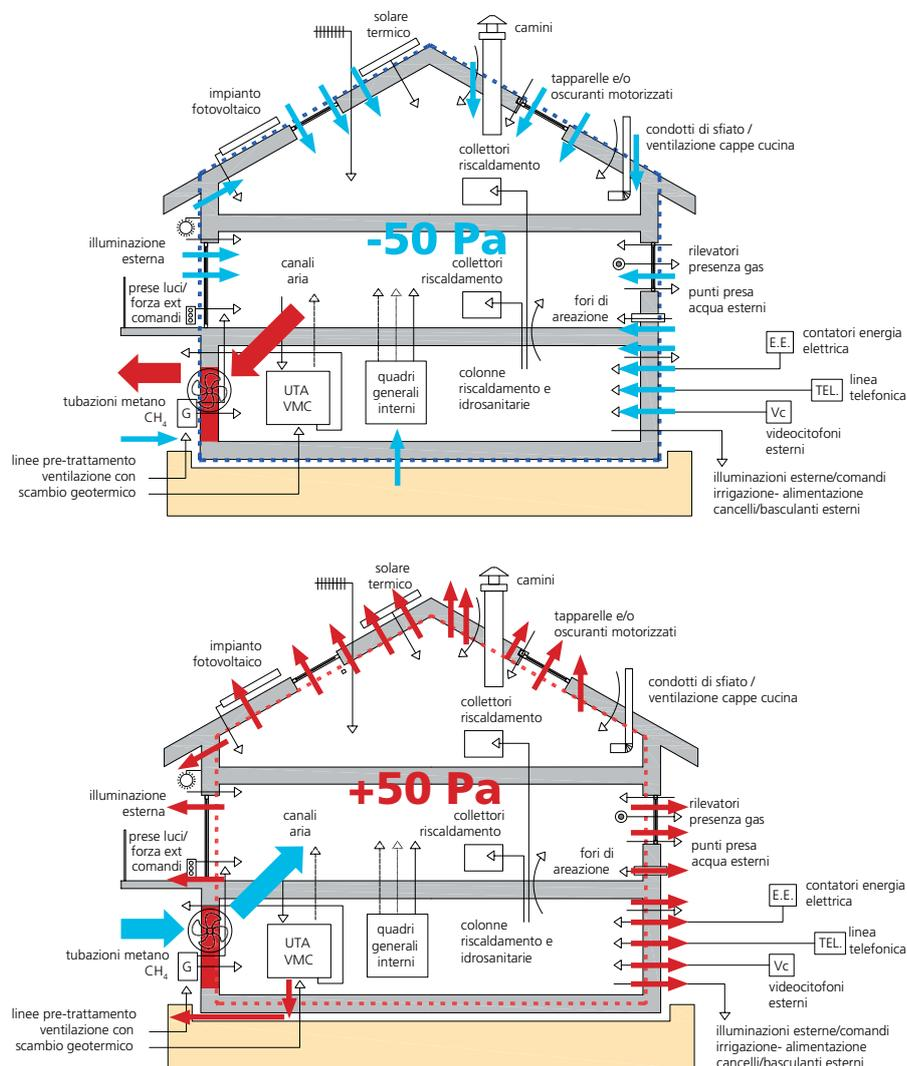
Si consiglia inoltre di effettuare un pre-test durante le fasi di cantiere grezzo al fine di identificare difformità di tenuta all'aria nell'involucro edilizio prima di completare le finiture.
