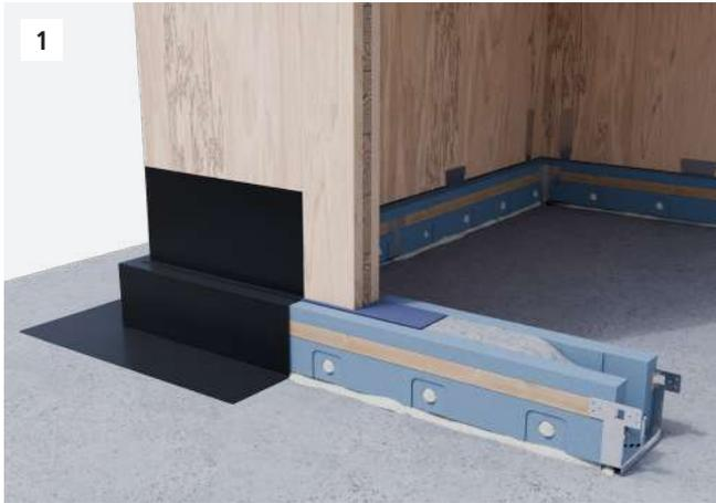
1 Nel caso di struttura in legno posizionare la parete su cordolo Radisol. Posizionare una guaina apposta anti umidità di risalita tra cordolo e parete e una guaina impermeabilizzante e anti-radice sull'esterno.
