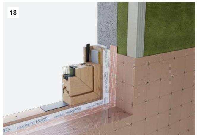
In corrispondenza delle interruzioni di facciata, quali ad esempio il foro finestra, sigillare a regola d'arte con appositi materiali, il freno al vapore per ridurre al minimo il rischio di formazione di condensa.
