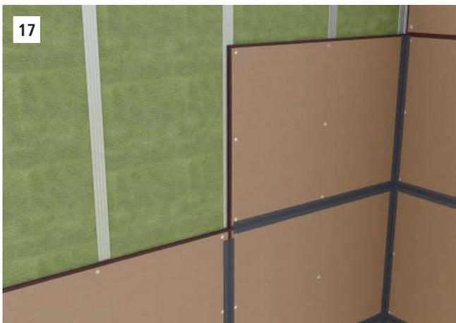
Posa della lastra acustica ancorata sulla struttura portante della finitura a cartongesso. Curare nei minimi dettagli, con gli appositi accessori di sistema, la sigillatura delle lastre al fine di ottimizzarne le prestazioni.
