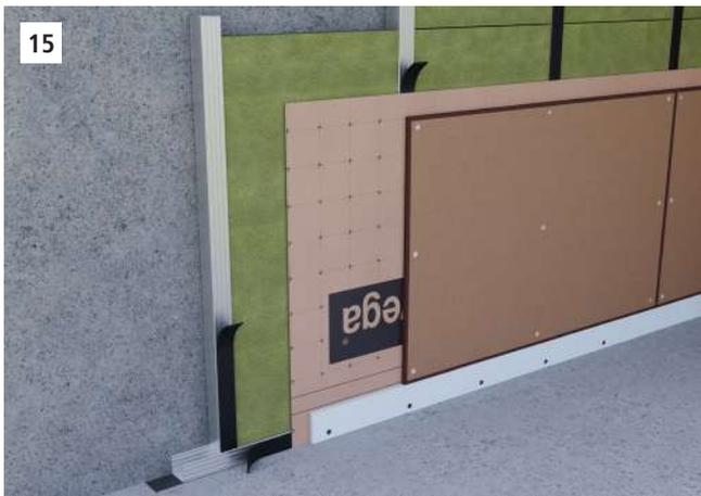
Nel caso in cui il freno al vapore venisse posato sulla struttura del cartongesso, utilizzare l'apposito nastro biadesivo butilico sigillante al chiodo per stabilizzare il freno al vapore e garantire l'impermeabilità.
