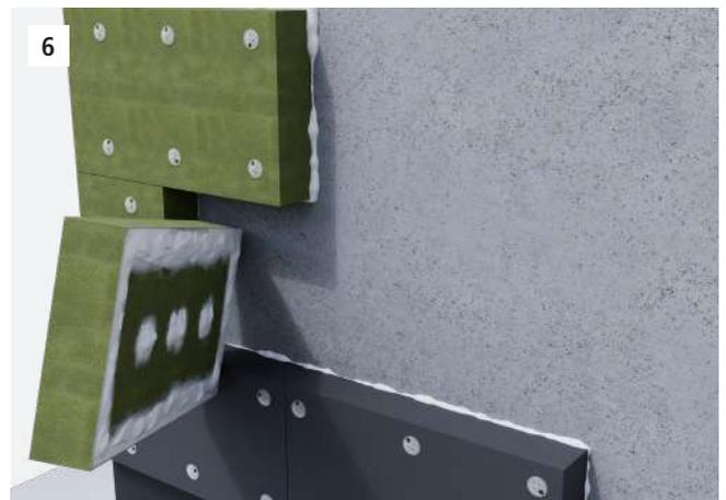
6 Nel caso di cappotto intonacato, posizionare i pannelli isolanti con apposito collante a tutta superficie o a cordoli e punti. Completare la posa con appositi tasselli. Eseguire la zoccolatura con pannelli in EPS.
