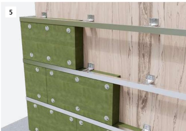
5 Nel caso di facciata ventilata, posare tra la struttura di supporto metallica i pannelli isolanti. Se necessario, ancorarli alla parete per stabilizzarli.
