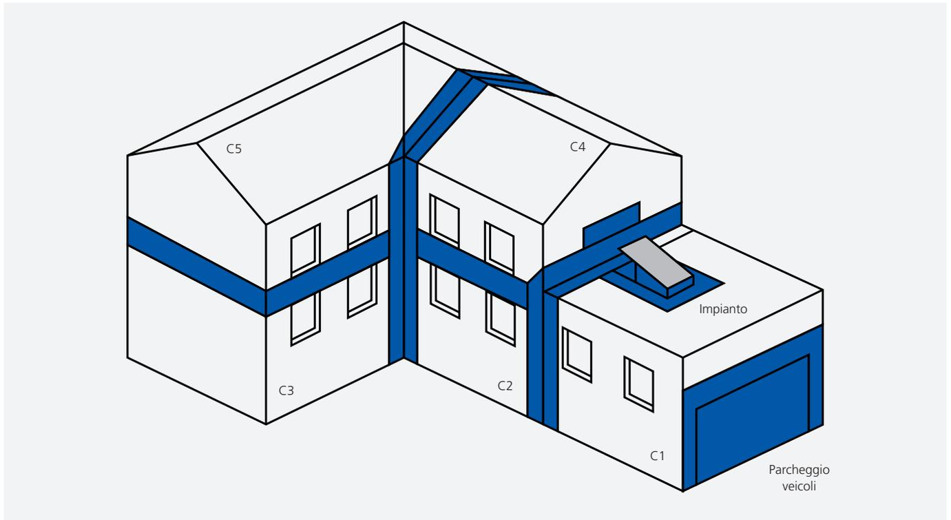
Nella sezione 5 della **RTV 13** vengono invece descritte, per i vari elementi tecnici costituenti le chiusure d'ambito, le caratteristiche materiche e geometriche delle fasce di separazione da realizzare per garantire la sicurezza antincendio secondo le modalità d'applicazione precedentemente descritte.
