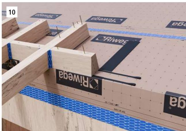
Sigillare a regola d'arte tutti i punti di interruzione e tutte le connessioni delle struttura con appositi materiali di sigillatura quali guarnizioni in EPDM e/o guarnizioni a espansione.
